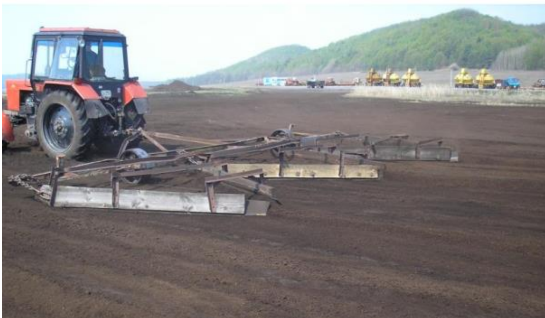
Рисунок 1.12. Технологічна операція – валкування фрезерного торфу (приклад)
