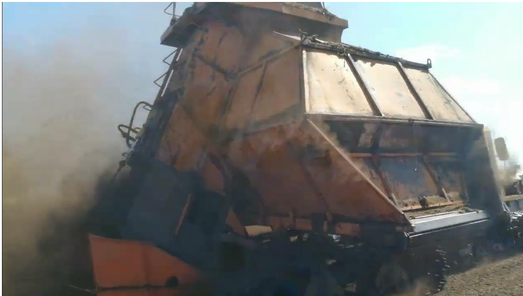
Рисунок 1.13. Технологічна операція – збирання торфу скреперно-бункерними машинами (приклад)
