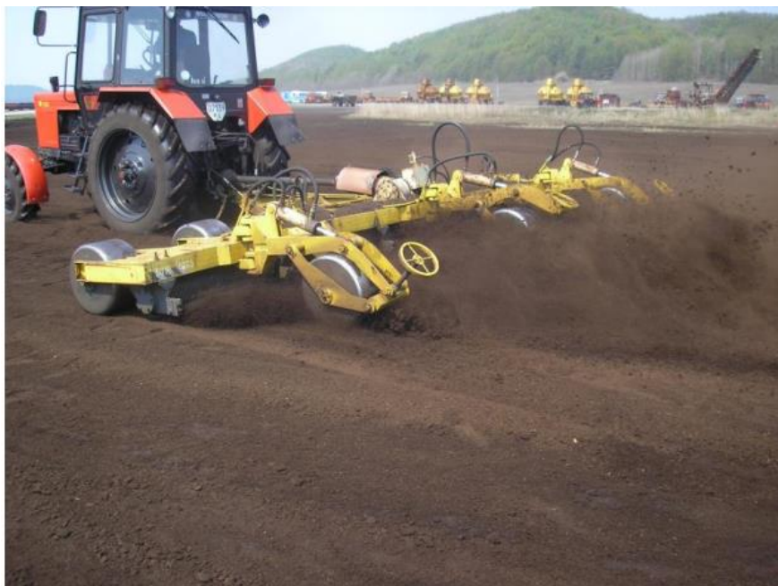
Рисунок 1.10. Технологічна операція – фрезерування торфу (приклад) (фрезерний барабан МТФ-13М (Україна))
