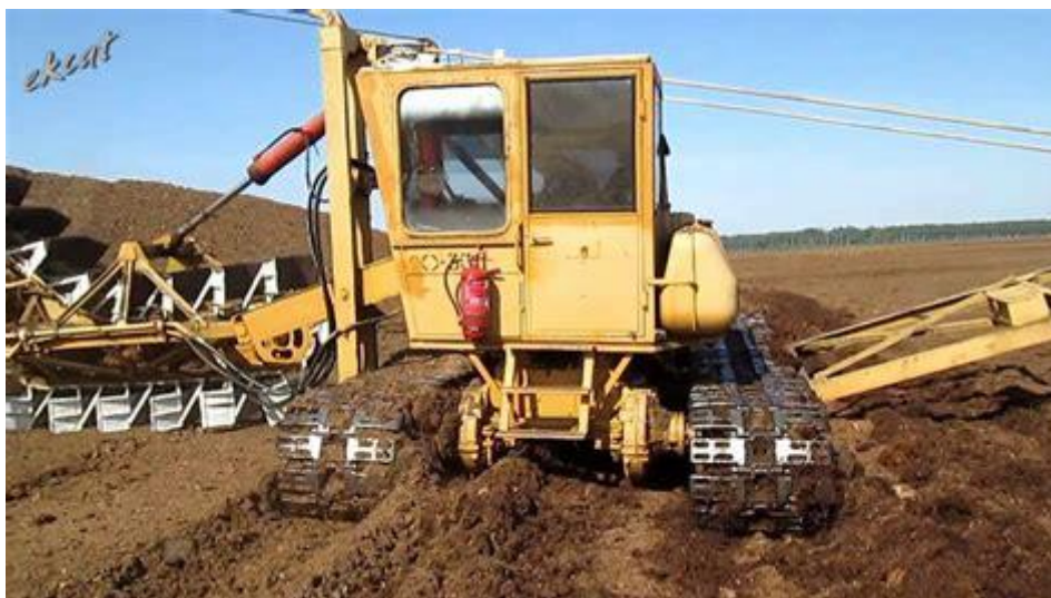
Рисунок 1.15. Технологічна операція – штабелювання торфу (приклад)
